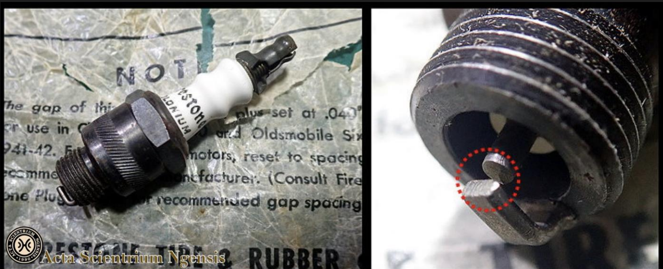
上圖：(PO-02圖解)1940年代美國燧石輪胎公司(Firestone)出品的火星塞(Spark plug)，聲稱在點火器中(紅色虛線圓形位置)的金屬接點中曾安置有含微量鈾元素，但由於年代久遠，編者對樣本進行核輻射測試，未發現放射性。圖片來源：延陵科學綜合室藏
